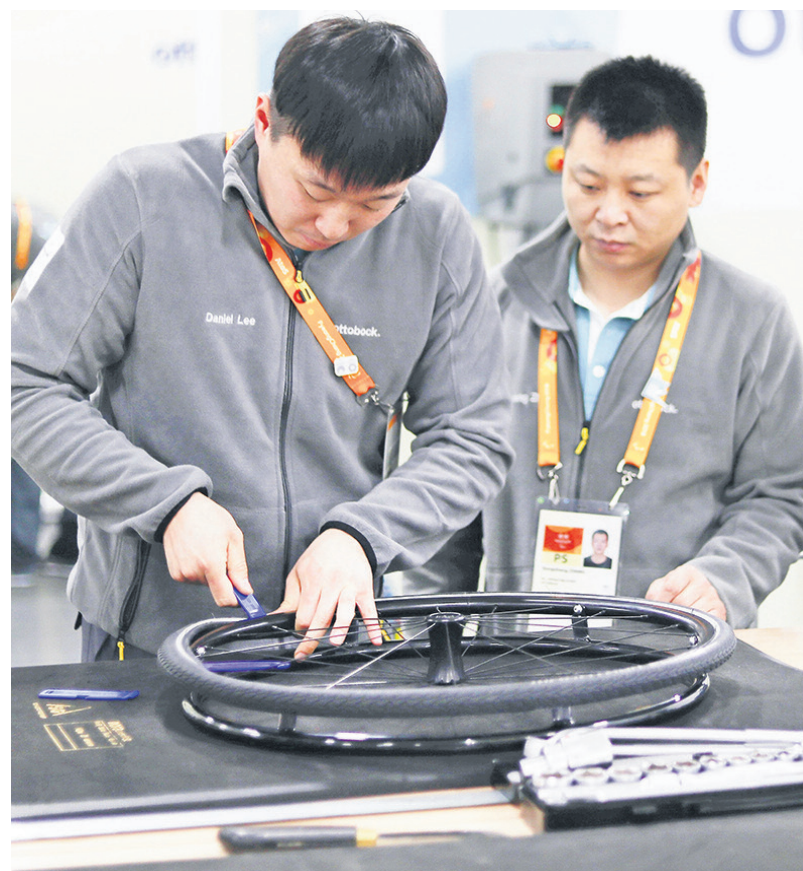
Die technischen Experten der Ottobock-Werkstatt kümmern sich auch um die Alltags-Hilfsmittel der Athleten. Hier wird der Reifen eines Rollstuhls gewechselt, bei den Paralympics in Pyeong Chang 2018.
