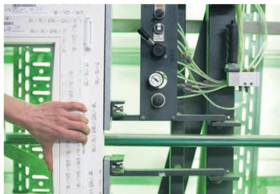
Prüfung von Glaseinschlüssen mittels Grünlicht in einem Betrieb mit RAL-Gütezeichen.
