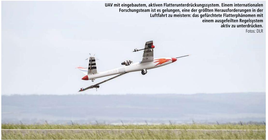
UAV mit eingebautem, aktiven Flatterunterdrückungssystem. Einem internationalen Forscherteam ist es gelungen, eine der größten Herausforderungen in der Luftfahrt zu meistern: das gefürchtete Flatterphänomen mit einem ausgefeilten Regelsystem aktiv zu unterdrücken.
