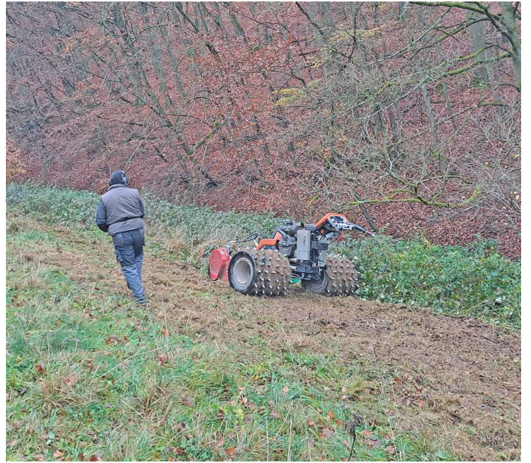
Der Spezialmulcher mit Fernsteuerung kommt eigentlich in alpinen Steillagen zum Einsatz, aber auch in Südniedersachsen macht er einen guten Job. Foto: Niedersächsische Landesforsten
