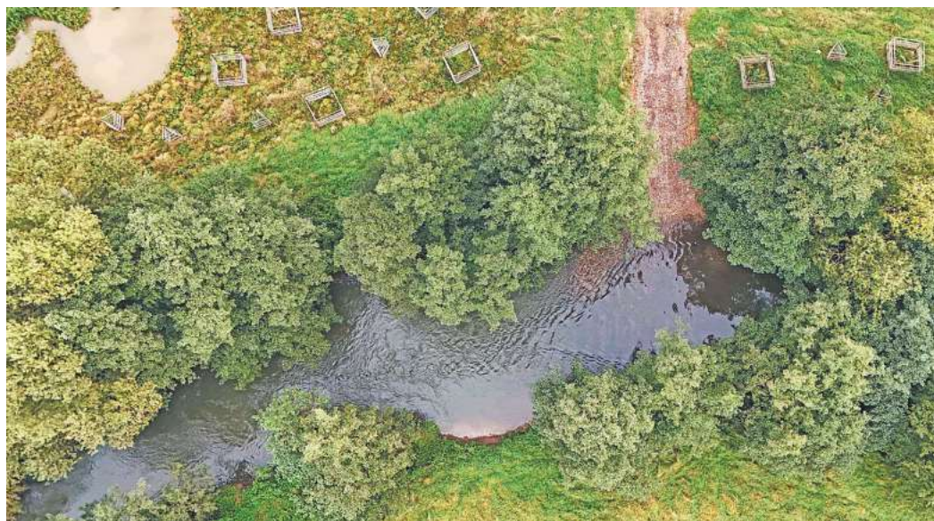
Das Ergebnis der Arbeiten an der Rhume: Die Strömungsvariabilität wurde durch die Kiesrausche in der Rhume gesteigert. Ein Verblisschutz sichert den Erfolg der Neuanpflanzungen. Oben links ist der gewünschte Wasserrückhalt in der Fläche erkennbar. Fotos: Kathrin Moggert / NLWKN
